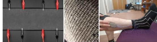
Piezoresistiivistä kangasta ja sukkaan kudottu paineanturi.
