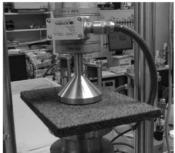
KUVA 1. Testattavan alustan (WS) staattisen jäykkyyden määrittäminen (kuvassa puristuslevyn halkaisija on 100 mm)
