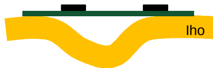
Perinteinen piirilevypohjainen elektroniikka
