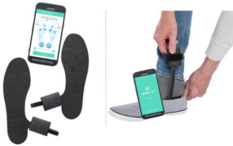
Mobiili kävelyn ja liikkumisen mittalaite (Movesole Oy)
