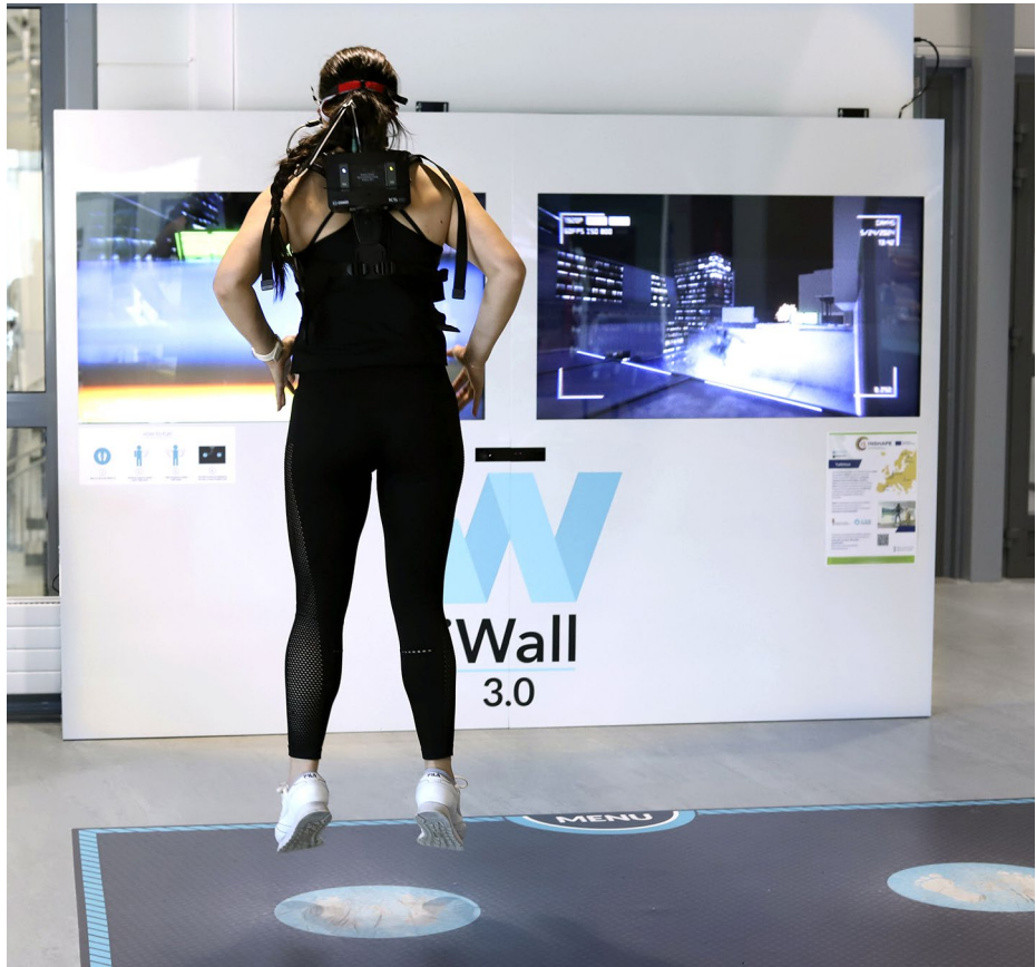
JYU-Vuokatti ja CSE tutkivat iWall -liikuntapeliin fyysistä kuormittavuutta. Hengityskaasuja mitattiin kannettavalla COSMED K5 -spiroergometrilaitteistolla. Kuva: Satu Kämäräinen.
